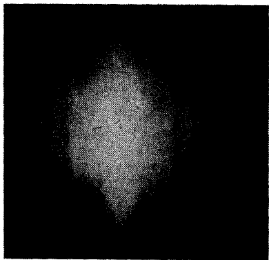
Рис. XXIII.12. Увеличенное изображение картины фраунгоферовской дифракции монохроматического излучения, вырезанного из пучка СИ накопителя ВЭПП-3 ИЯФ СО АН СССР (1975 г.).
